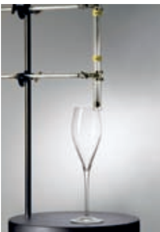
Prova resistenza bordo Rim impact test
